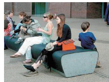
그림 12. 앉음판에 우레탄을 부착하여 사용자 편의성을 높인 예
